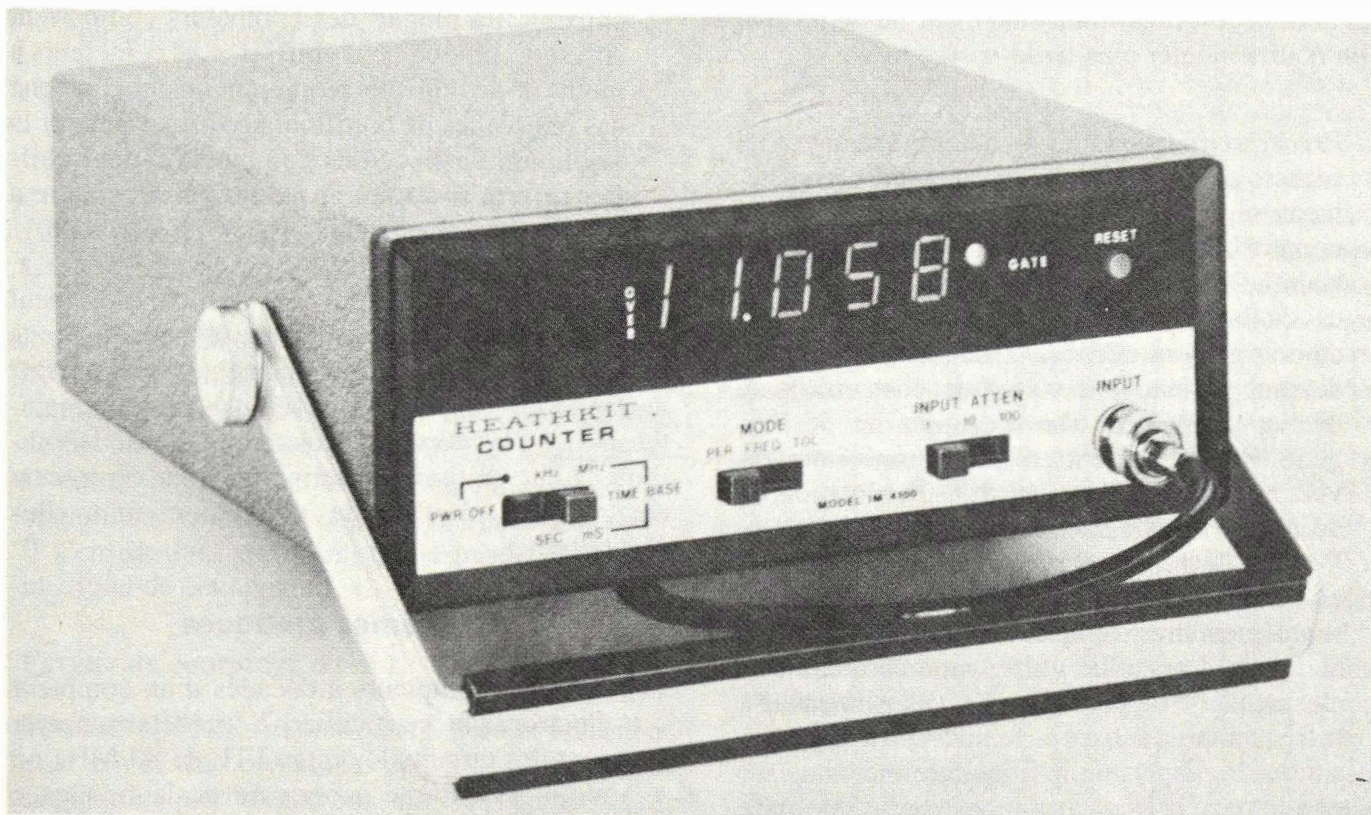
Figure 10-2 Compteur électronique de prix modique comportant seulement deux intervalles de portillonnage. Notons que ces intervalles sont exprimés en fréquence et en temps pour un usage en fréquencemètre et en périodemètre. (Document: Heath Company.)
