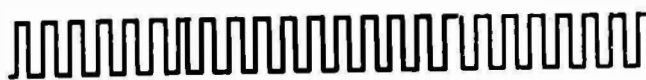
Figure 11-24 Second balayage selon le mode alternat. Ce balayage a été déclenché par le balayage illustré à la figure 11-23.
