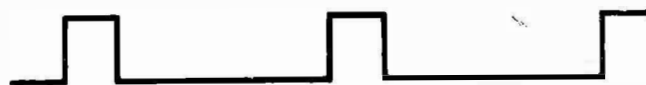
Figure 11-23 Premier balayage selon le mode alternat. Ce signal est le signal de déclenchement.
